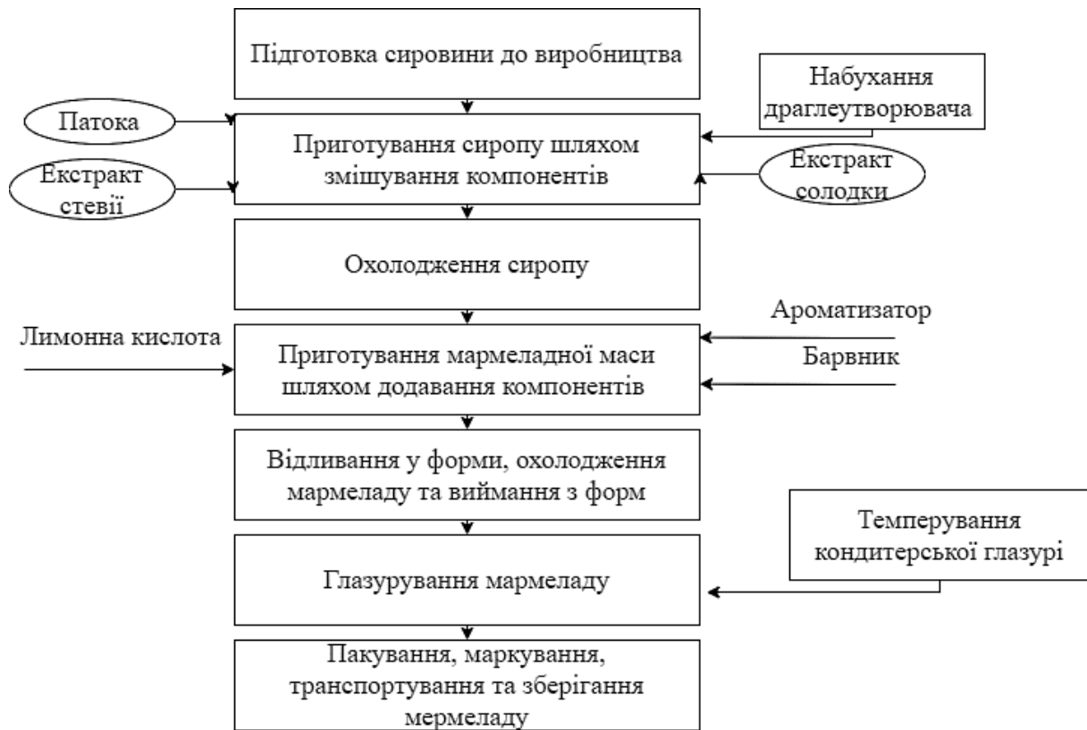
Рисунок 1 – Технологічна принципова схема виробництва желейного мармеладу
